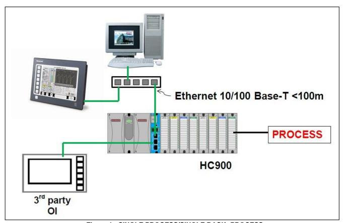
Figure 1 - SINGLE PROCESS/SINGLE RACK- PROCESS
